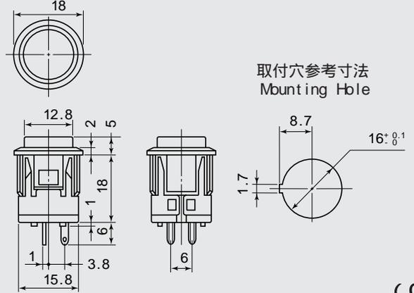
取付パネル厚 1~ 2.5mm (推奨パネル厚 1.5~ 2mm)
