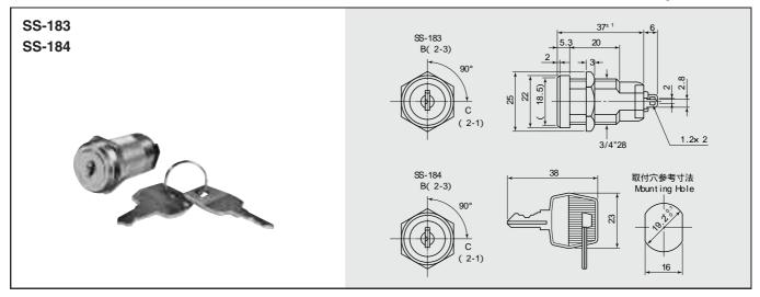
SS-183..鍵は1位置だけで抜き差しが可能です。(キーロック式) SS-183..Key removable in CFF( B) position only(.ON)( C) position Lock Key Type.)
