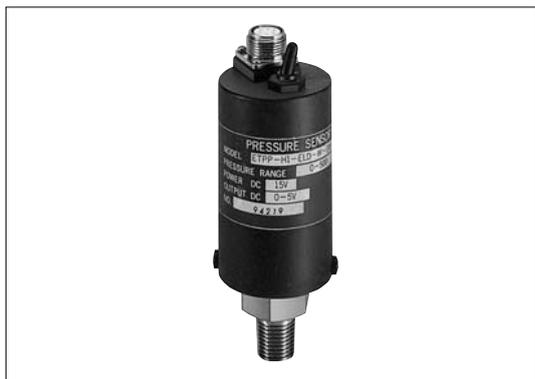
●ETP形圧力センサは、蒸着形半導体ひずみゲージを用いた圧力検出部と増幅回路を内蔵した圧力発信器です。
